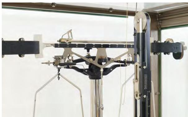
Abb. 6: Permanent-Magnetdämpfung
