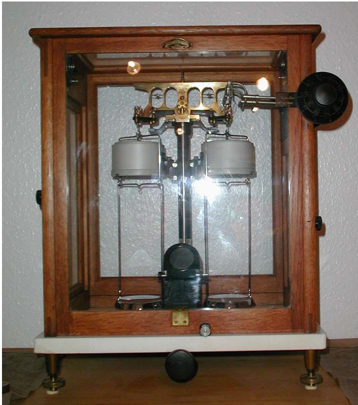
Abb. 20: Analysenwaage D 3 „Proja“ der Sartorius AG, Göttingen, mit Auflage der beiden Dekaden der Zehner- und Hunderter-Milligramme auf mit dem Balkengehänge verbundene Auflagevorrichtung durch in Balkenhöhe konzentrisch angeordnete zwei Schaltknöpfe über Wellen und doppelte Nockenwelle; Anzeige der Gewichtsauslage durch gegenüber den Schaltknöpfen angebrachten Pfeil, 1934. Quelle: Katalog Sartorius 1934, Anm. 66.
